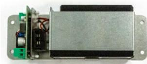
Contenuto del kit: 2 batterie tampone 12V 0.8A/h, 1 scheda elettronica.
